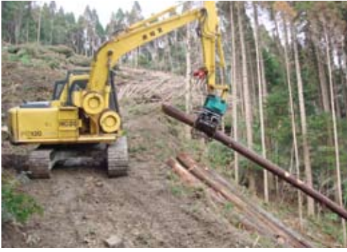
スイングヤードによる集材作業
