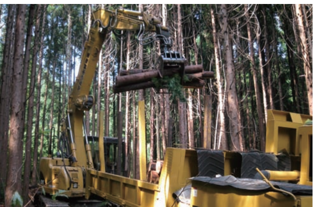
間伐材のフォワーダへの積み込み (宮城県泉仙台市 小屋森国有林)
