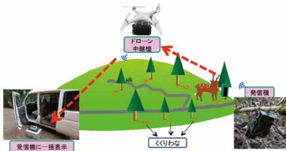
図2 無人航空機を活用したシカ捕獲通知システムの模式図
