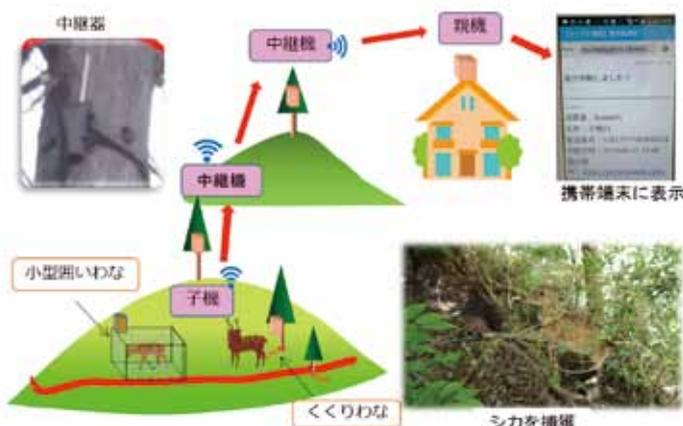
図1 簡易無線通信を活用したシカわな遠隔捕獲通知システムの開発・実証
