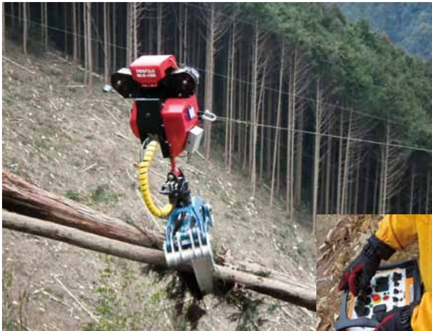
ロージンググラップル： 遠隔操作で荷を掴む集材機械
