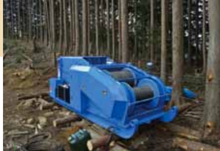
集材の自動化を実現する油圧制御の集材機
