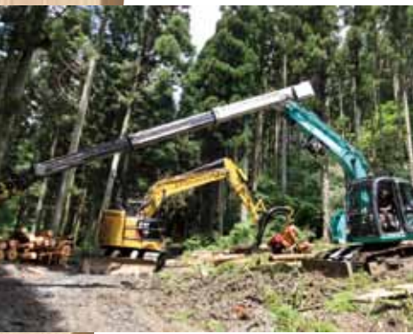
ヘッド固定式ロングリーチグラブとツインソー装着のハーベスタによる間伐作業
