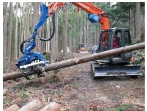
ハーベスタによる造材作業
