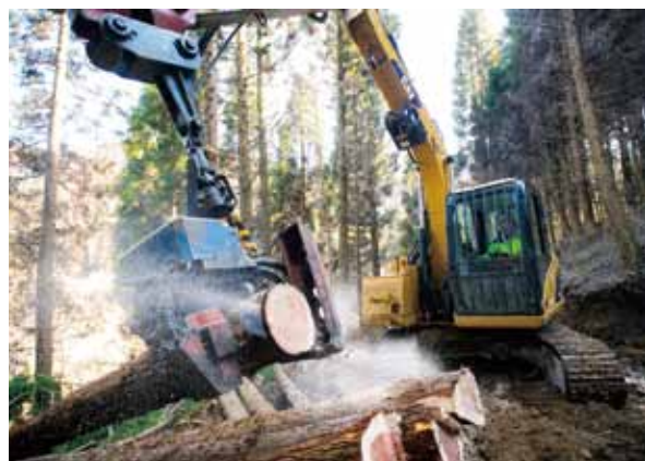
高性能林業機械による間伐
