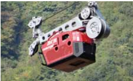
自走式搬器 ：小型化された高性能エンジンを搭載。走行速度や木材の吊り上げ能力を改良。
