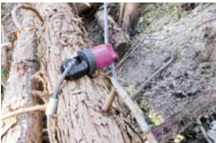
オートフック ：荷掛けしたロープをリモコン操作により取り外し可能で、作業の迅速化や安全性が向上。
