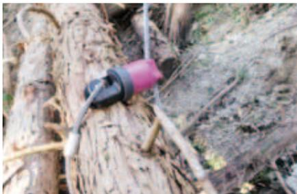
**オートフック**：荷掛けしたロープをリモコン操作により取り外し可能で、作業の迅速化や安全性が向上。
