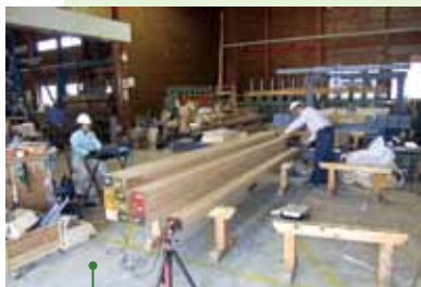
製材後のコウヨウザン簡易強度試験
