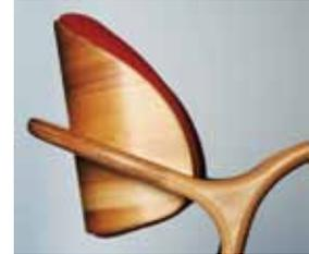
独自技術で強度を高めたスギなどの針葉樹の単板を使用し、自由な曲線を持つ丈夫な部材を作る、世界初の技術。
