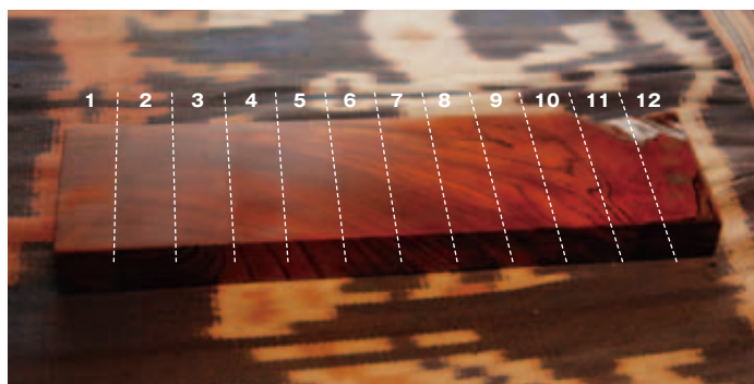
▲写真の板は重ね塗りした漆を段階的に示したもの。右にいくに連れて光沢が増している様子が見てとれる(拭漆の工程)
