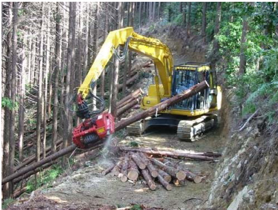
間伐した木を高性能林業機械により丸太にしているところ（九州森林管理局）
