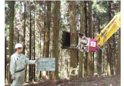
高性能林業機械による伐倒の様子
