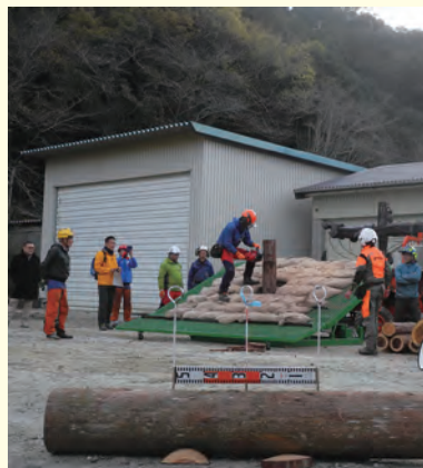
和歌山県農林大学校林業研修部でのFelling Trainer MTW-01を使用した伐倒練習の様子
