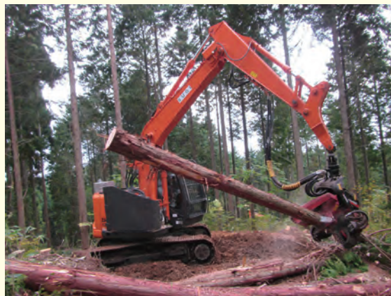
フィンランドのWaratah社製「iLoggerバリューバッキング」を搭載したハーベスタ
