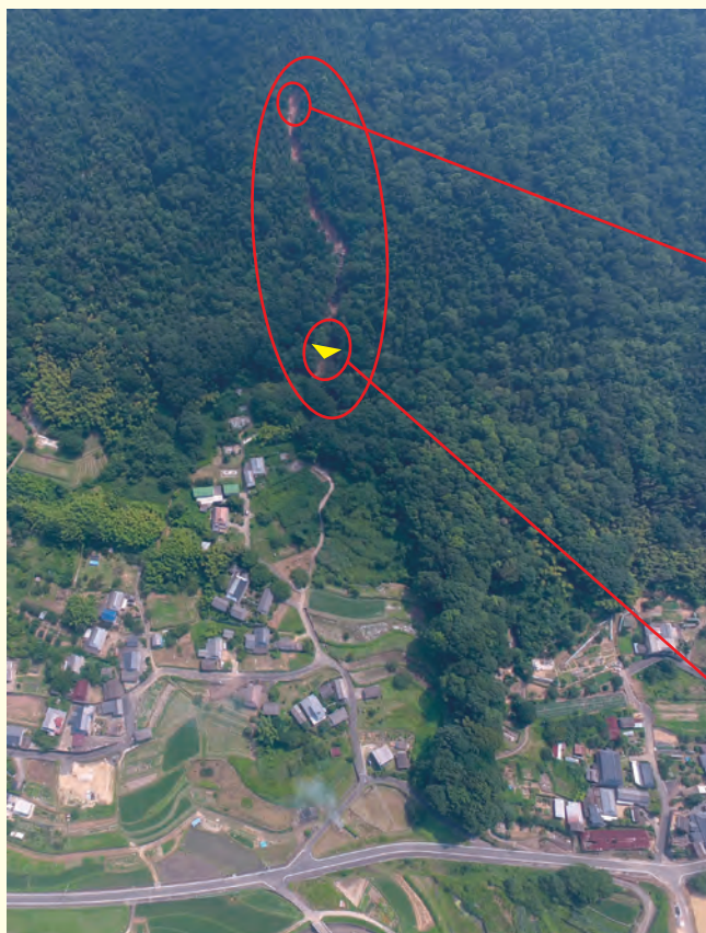
治山ダム(昭和42年度施工)による流木の流出等の抑制効果(岡山県笠岡市吉田地区)
