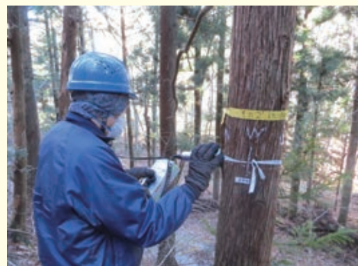
樹皮の放射性物質濃度測定(GM計数管式サーベイメータ による4方位表面計数率の測定:スギ) (田村市)
