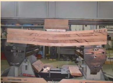
CLTの強度試験
