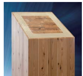
平成26(2014)年に初めて開発された2時間の耐火性能を有する耐火集成材(内部の荷重支持部に集成材を使用し、その外側を石膏ボードで覆い、表面材に木材を使用したもの)
