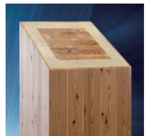
平成26(2014)年に初めて開発された2時間の耐火性能を有する耐火集成材(内部の荷重支持部に集成材を使用し、その外側を石膏ボードで覆い、表面材に木材を使用したもの)
