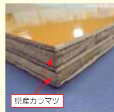
国産材型枠用合板の構成
