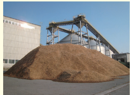
木質系災害廃棄物をチップ化した バイオマスボイラーの燃料
