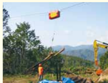
荷揚げ用ウインチを内蔵した高性能搬器
