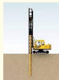
重機により保存処理木材を圧入
