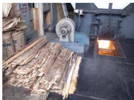
チップボイラー(右奥)と燃料となる工場残材(手前)
