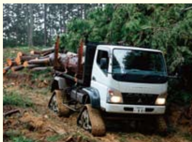
② クローラ式運材トラック
