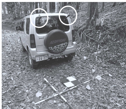
図-1 ビデオカメラ（白色円内）を取り付けた試験車両
