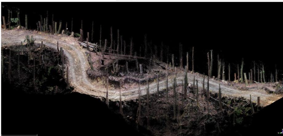
図-7 地上型 3D レーザスキャナ FARO で計測した三次元点群データ (上図) と動画から作成した三次元点群データとを重ね合わせた図 (下図)
