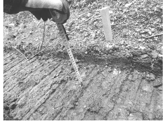
図-2 路面高の計測
