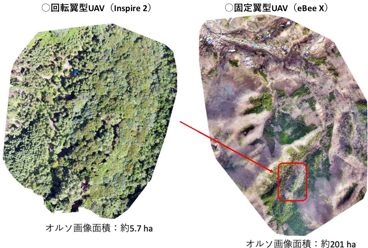
図-4 回転翼型 UAV (左) と固定翼型 UAV (右) による空撮画像から作成したオルソモザイク画像
