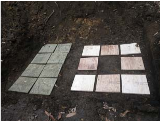
写真1 合板の埋設状態
