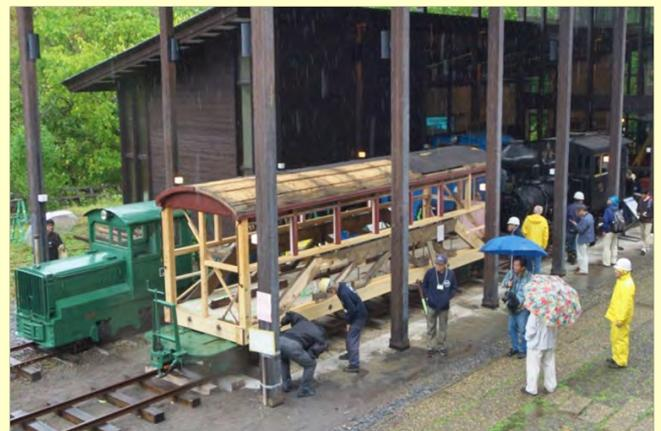
写真2. 台枠を組み立て、床を張り、柱、側面主構造、屋根根までを組み上げ、そして台車を履いた。やっと車両らしくなった。第6回根利森林鉄道まつりでは、雨にもかかわらず、大勢の人に修復過程をご覧になっていた。P: 木村一博
