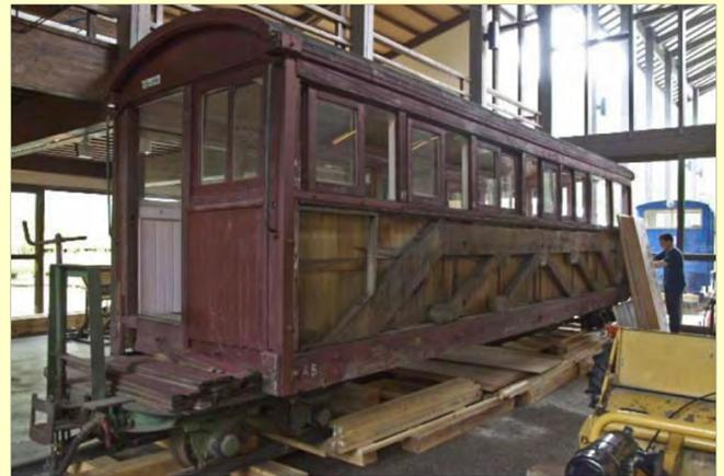
写真1. 修復作業前、林業機械化センター親機館に收容されたB型客車15号。側面のトラス構造が観察できる。
