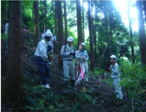
現地実習（現地踏査～予測～中心線・縦断・横断測量）（講義「林道の調査・設計及び低コスト化の実務」）八王子市 城山国有林内
