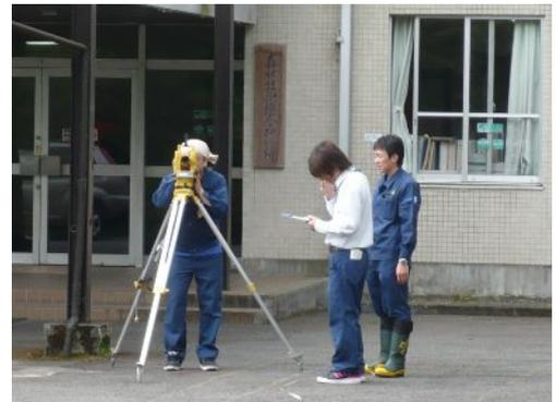
次の日には、測量野帳をもとに平面図・縦断面図・横断面図を作成し土量の算出したところ、残土が出てしまい「最後の点の中心線をずらせばよかったね」などと言いながら、林道の調査・設計には、技術と経験が必要なんだと痛感したところです。
