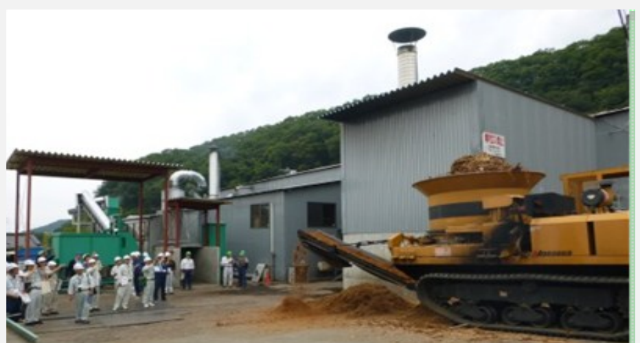
移動式破砕機によりパーク（樹皮）を燃料として扱いやすい形状に加工
