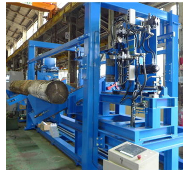
(図1) 丸太形状測定装置を統合した大径材製材実証機
