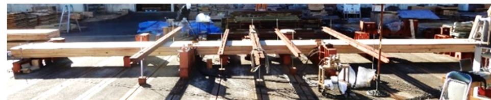
(図3) 枠組壁工法による12m梁試験体の曲げ破壊試験
