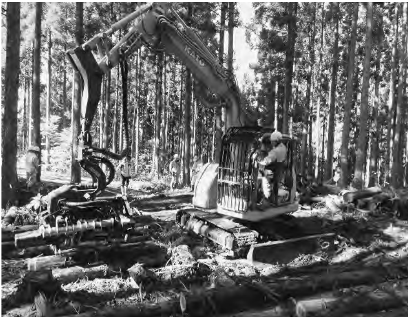
ハーベスタ指導では、安全な作業とホースを損傷しないように、手元を見るだけでなく、視野を広くもつよう心掛けている
