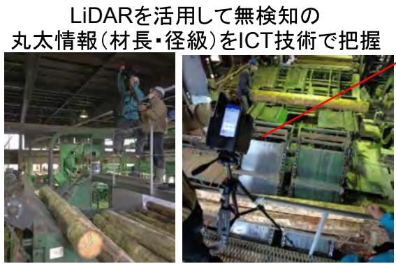
低価格なLiDAR計測機器を
