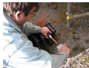
木製丸棒で取出力を計測
