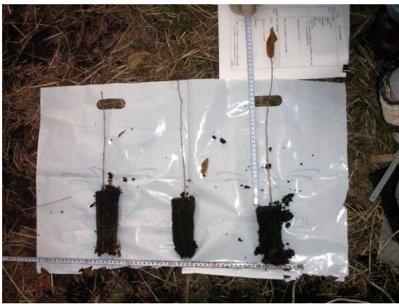
木製丸棒で取出したクヌギコンテナ苗 (JFA-300) 根鉢の一部崩れる
