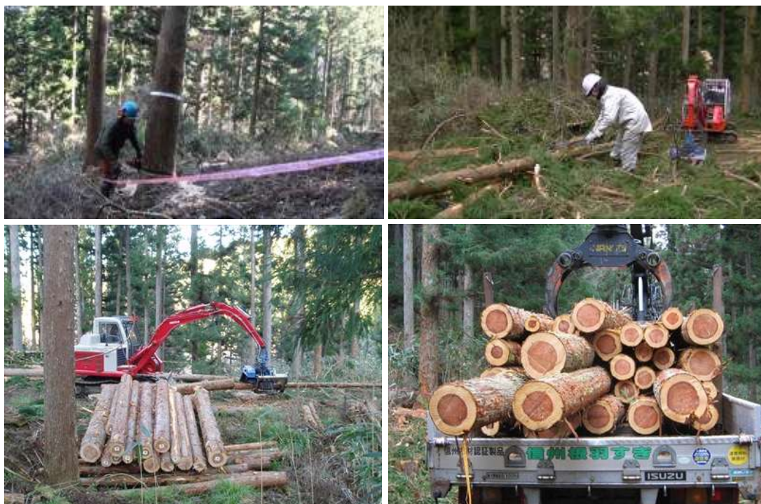
写真 3.13 伐採時の作業システム (左上:伐倒、右上:荷掛け、左下:造材、右下:積込)
