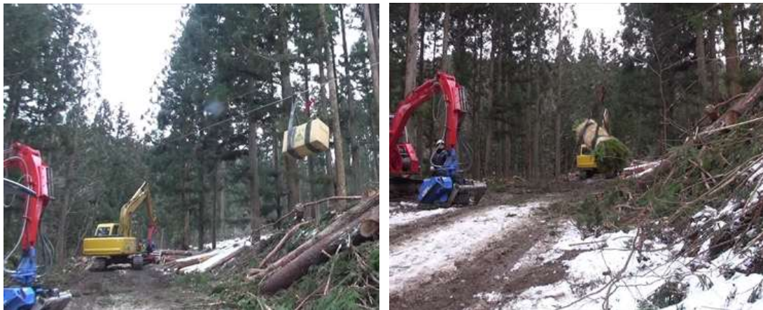
写真 3.14 架線を利用した苗木運搬（左：コンテナ苗、右：普通苗）
