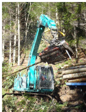
プロセッサによる枝払・玉切・積み込み
