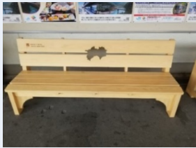
【設置後1年2ヶ月経過した塗装ベンチ】 写真提供：玄々化学工業（株）
