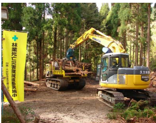
グラップルによるフォワーダへの積み込み
