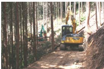
☆高密度路網によるハーベスタ・グラップル・フォワーダによる一連の作業システム
