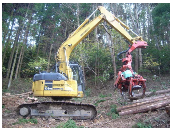
作業路上で造材作業するプロセッサ
