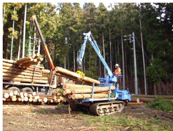
フォワーダによる山土場での積み降ろし作業
