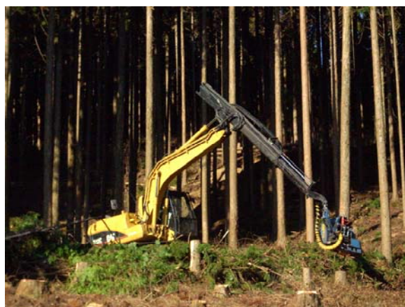
ロングアームハーベスタによる伐倒(皆伐)作業
