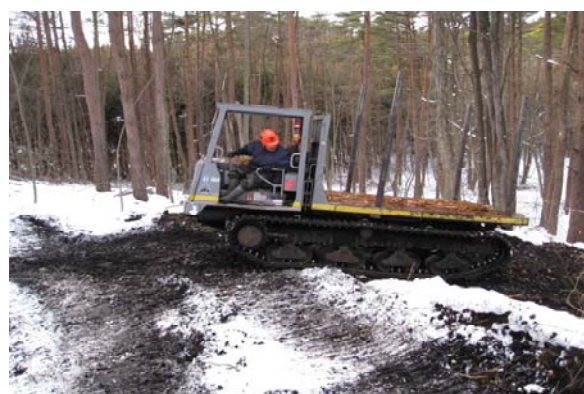
路体保護のためスイッチバックも多用
