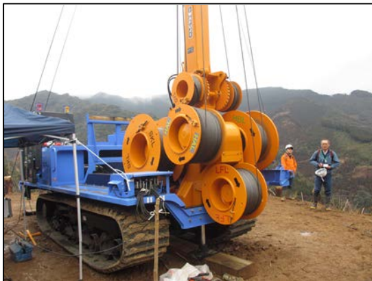
【タワーヤードによる集材】
