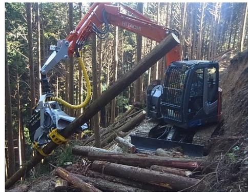
【ストローク式ハーベスタ（クレーン）による造材作業】
