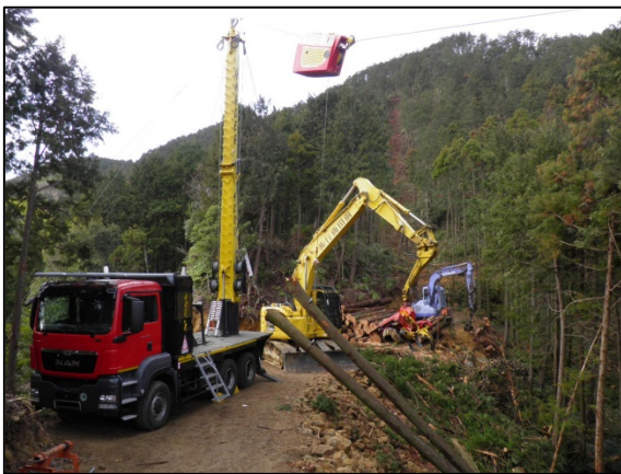
【タワーヤーダ―による全木集材】
