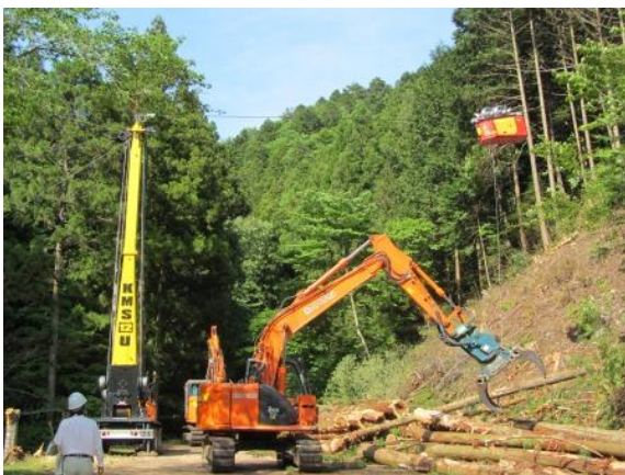
【タワーヤーダと高性能搬器での集材】
